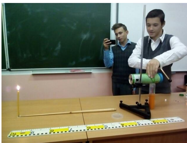
Ударная волна сбивает пламя свечи. Цилиндр играет роль барабана. Новое понятие –ударная звуковая волна.
